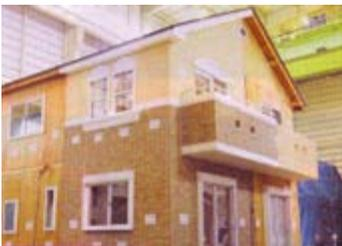
耐震実験にて、阪神淡路大震災、ロサンゼルス地震、新潟県中越地震、想定関東地震の4つの地震波を連続して加えても損傷ありませんでした。
